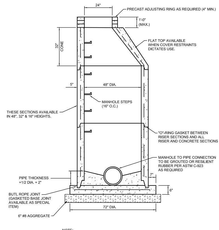
1.) MANHOLE CONFORMS TO A.S.T.M. C-478.
