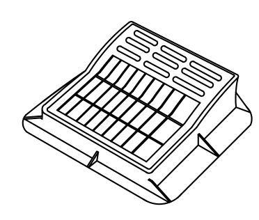
R-3501-T(L&R) NEENAH CURB INLET FRAME, GRATE & CURB BOX DETAIL
