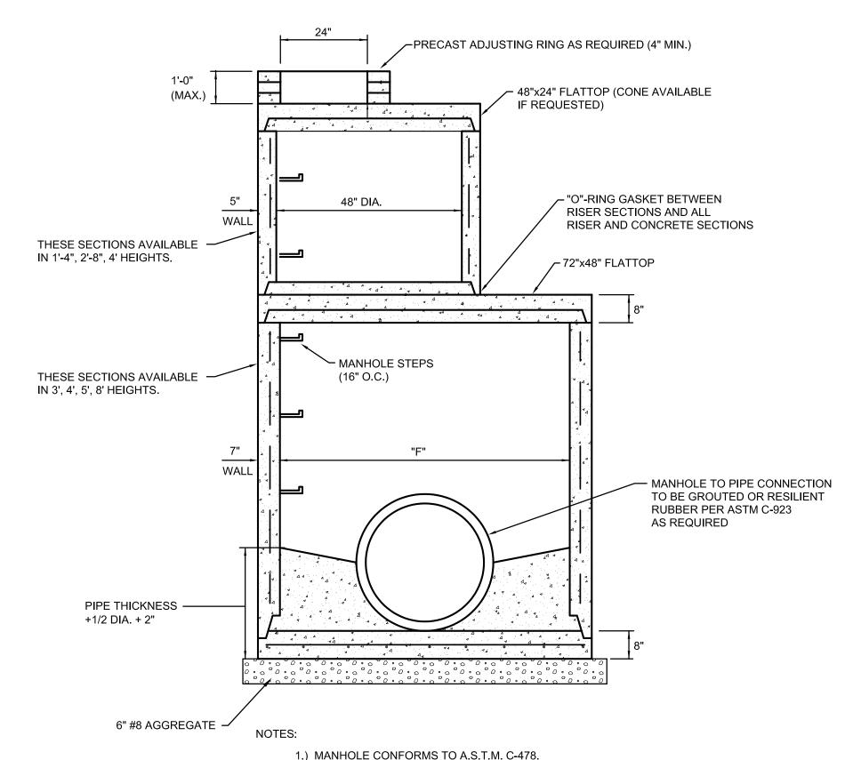
1.) MANHOLE CONFORMS TO A.S.T.M. C-478.
