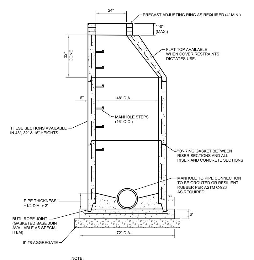
1.) MANHOLE CONFORMS TO A.S.T.M. C-478.
